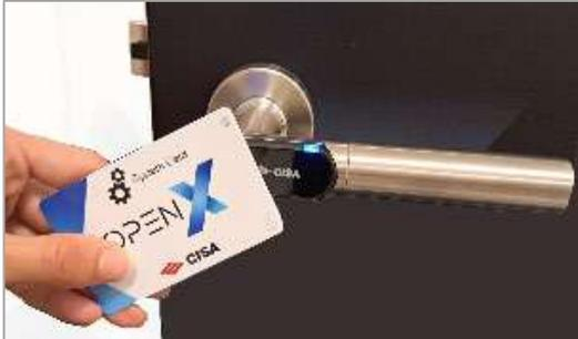
Avvicinare la System Card al dispositivo elettronico installato sulla porta.
