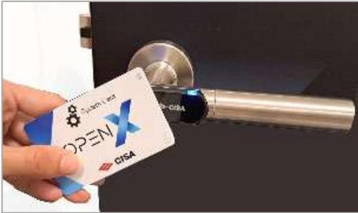
Avvicinare la System Card al dispositivo elettronico installato sulla porta.
